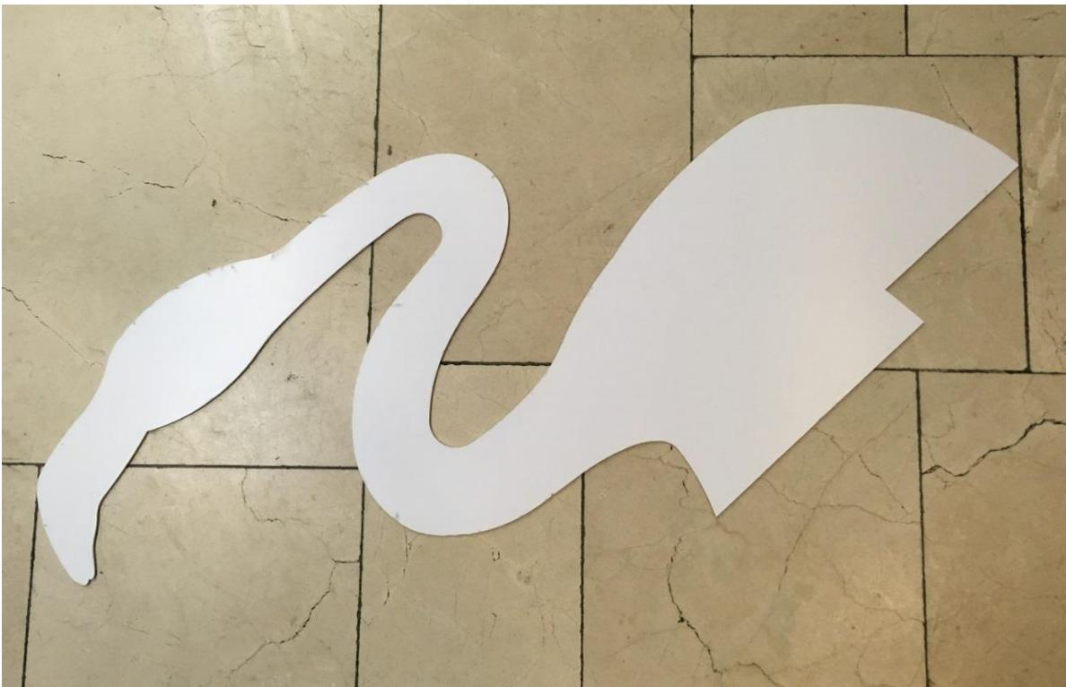
Die Funktion der PVC-Schaumstoffform besteht darin, sicherzustellen, dass die Messungen zwischen den Vetrile-Teilen, die den Mosaikeinsatz und dem Mosaikeinsatz selbst umgeben, übereinstimmen. Darüber hinaus wird die expandierte PVC-Schablone verwendet, um die
