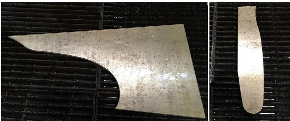
Anstelle des künstlerischen Mosaikeinsatzes wird ein expandiertes PVC-Profil auf Waterjet zugeschnitten die gleiche Form und die gleichen Abmessungen des Mosaikeinsatzes.
