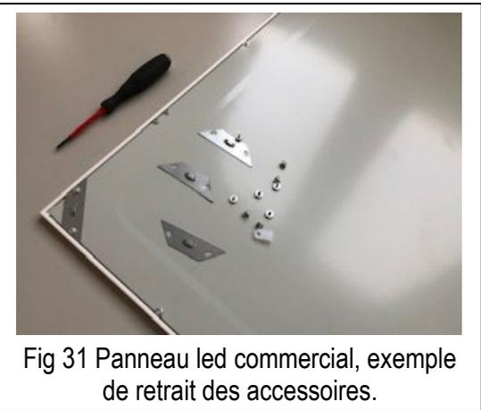
Fig 31 Panneau led commercial, exemple de retrait des accessoires.
