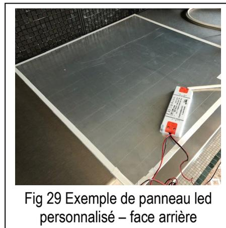
Fig 29 Exemple de panneau led personnalisé – face arrière
