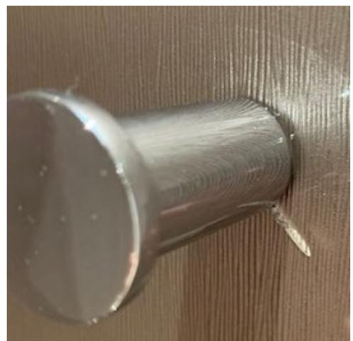
Fig 11 Exemple de serrage excessif
