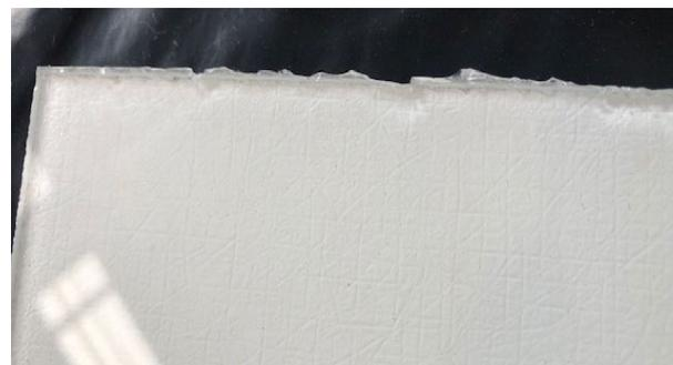
Fig 15 Exemple de coupe avec peu de sable, vitesse élevée – côté arrière
