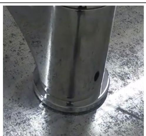
Fig 5 Exemple de serrage excessif
