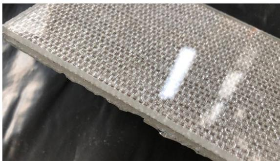
Fig 14 Exemple de coupe avec peu de sable, vitesse élevée – côté visible
