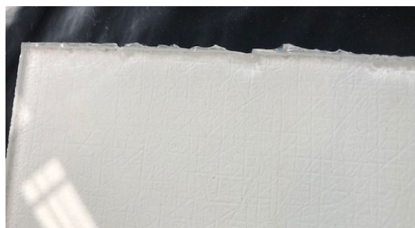
Fig 15 Ejemplo de corte con poca arena, elevada velocidad - lado trasero
