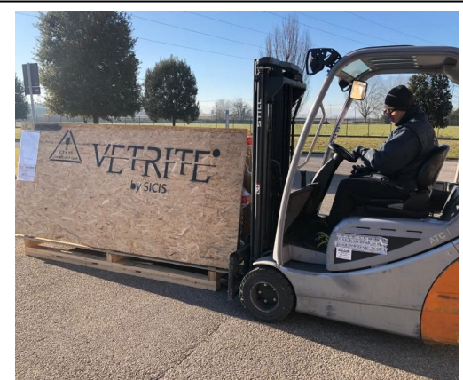
Fig 2 correcto desplazamiento de una caja de VETRITE
