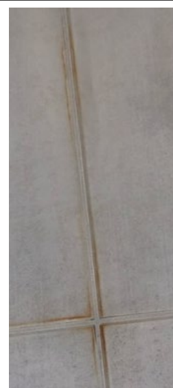
Fig 37 Ejemplo de contaminación por estaño.
