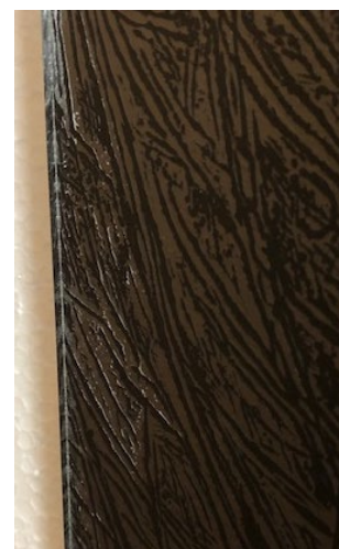
Fig. 21 Ejemplo de depósitos en el interior de la decoración
