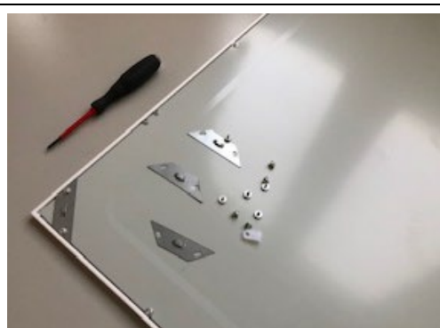
Fig 31 Panel led comercial, ejemplo de remoción de los accesorios.
