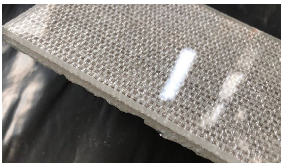
Fig 14 Ejemplo de corte con poca arena, elevada velocidad - lado a la vista
