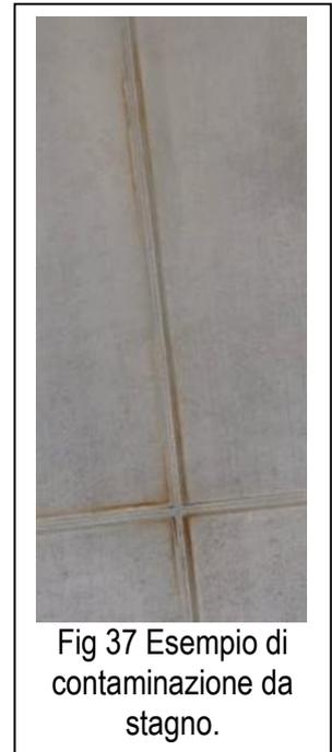
Fig 37 Esempio di contaminazione da stagno.
