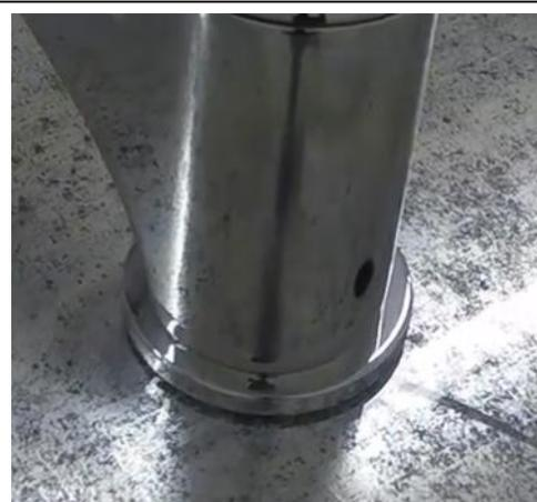
Fig 5 Esempio di serraggio eccessivo
