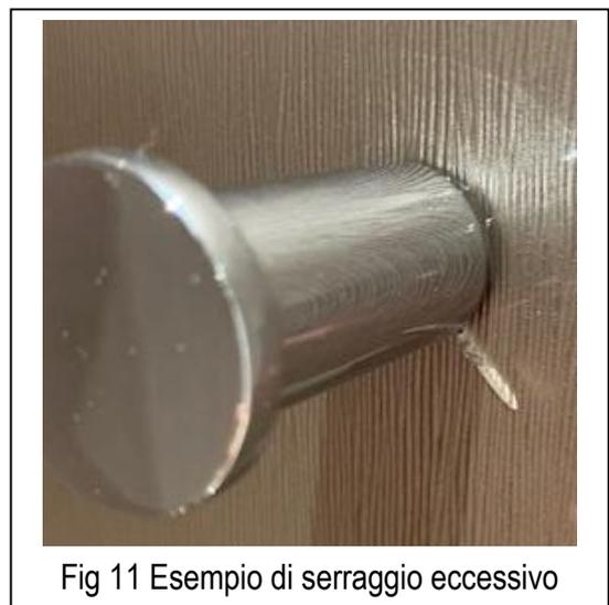
Fig 11 Esempio di serraggio eccessivo
