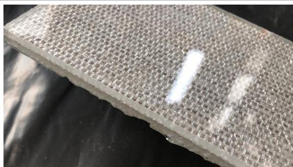
Fig 14 Esempio di taglio con poca sabbia, elevata velocità – lato a vista
