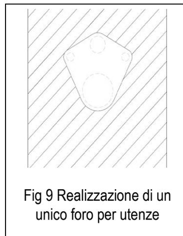
Fig 9 Realizzazione di un unico foro per utenze
