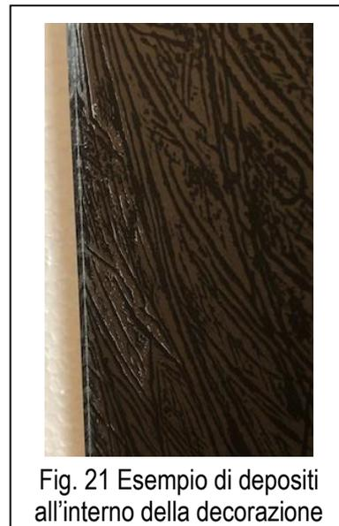
Fig. 21 Esempio di depositi all'interno della decorazione
