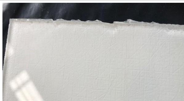
Fig 15 Esempio di taglio con poca sabbia, elevata velocità – lato posteriore
