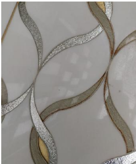
Feige 38 Beispiel für Kontamination aus Eisen
