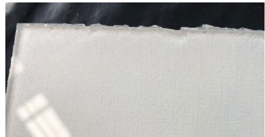
Abb. 15 Beispiel für Kanten mit Waterjet, bei dem zu wenig Schleifmittel verwendet wurde und die Schnittgeschwindigkeit zu hoch war
