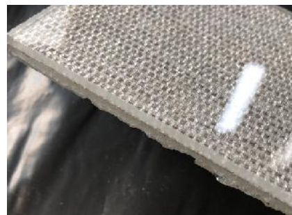
Abb. 14 Beispiel für eine Kante mit Waterjet, bei dem zu wenig
